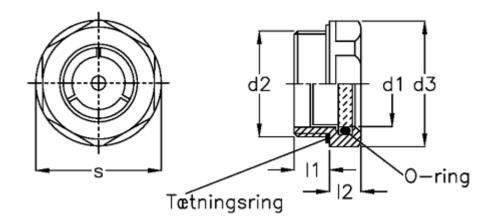
d1 = 11 d2 = M16x1,5 d3 = 22 l1 = 8.0 l2 = 7.5 Max pressure = -Max vacuum mbar = s = 20
